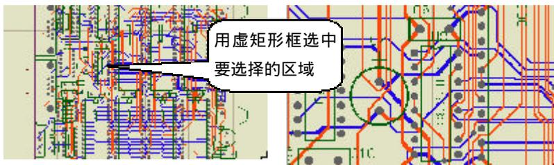
**6** 执行菜单命令 View/Around Point。执行该命令后，单击鼠标左键来确定目标区的中心点，接着再单击鼠标左键来确定目标区的半径的大小，如左图所示。执行菜单后，工作区显示的图形如右图所示。
