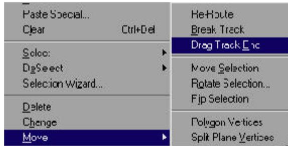
**2** 当拖动导线的中间位置时，如下图所示，它的使用方法与 Break Track 命令完全相同。使用光标将该导线进行拖动，移到一个新位置后，单击鼠标左键，即完成导线的重新放置，导线的两边都固定了。
